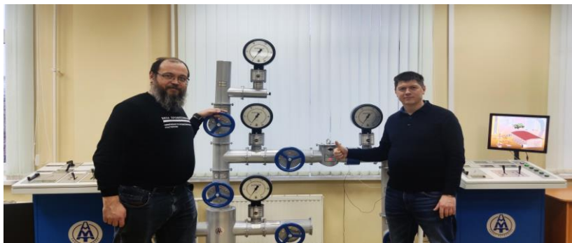
Рисунок 2 Выполнение практических задач на тренажере освоения скважин АМТ-601.
